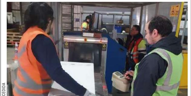
La Seremi de Salud de Magallanes realizó una evaluación de tasa de dosis por exposición a radiaciones mediante una cámara de ionización, en el marco del proceso de autorización de un equipo de rayos X para control de carga en el Aeropuerto Presidente Carlos Ibáñez del Campo.
