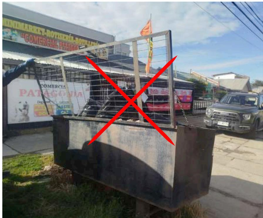
El receptáculo que debe tener asas, tapa y ruedas, debe permitir ser desplazado a la parte posterior del camión para ser volcado directamente por el alza contenedor y evitar con esto que las bolsas sean manipuladas por los auxiliares.
