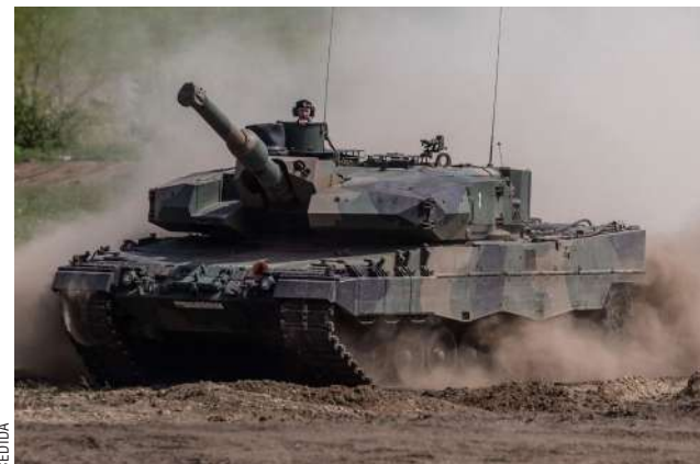
“El Leopard 2, un vehículo blindado de combate de fabricación alemana, que tiene una capacidad para cuatro soldados y pueden disparar a blancos a 5.000 metros de distancia”
